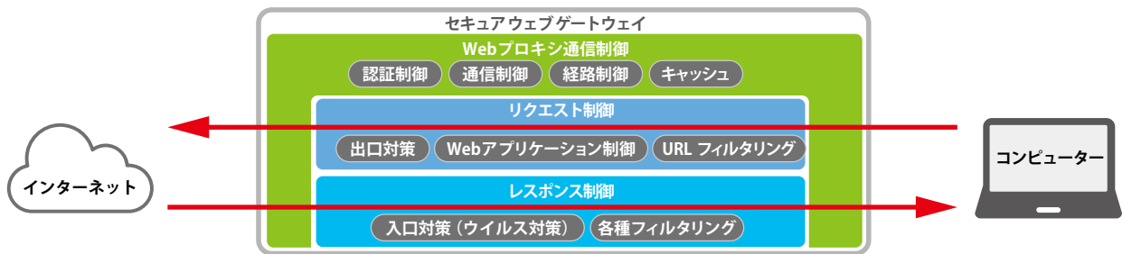
図 4 SWG の機能構成と通信の流れ
