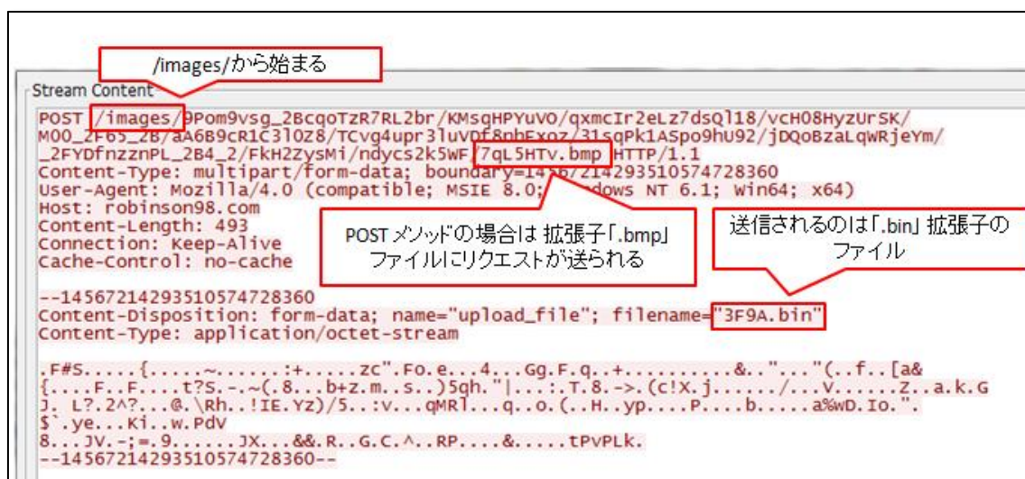
図 15 Ursnif 感染時の不審な HTTP 通信の検知例
