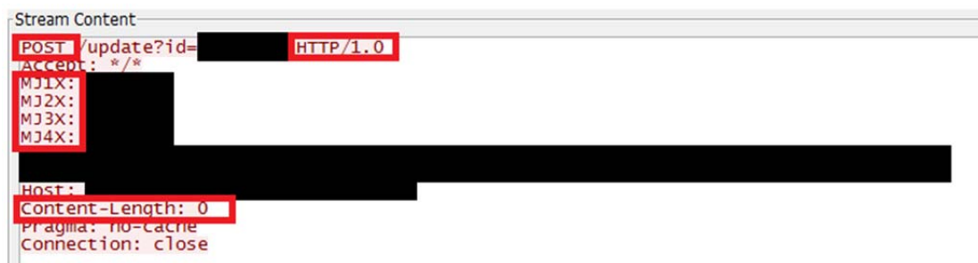
図 11 PlugX に感染したホストから発生する通信
